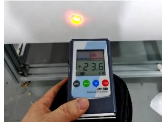
JN1500手持式静电测试仪是一个专门用于测定静电电压的简单仪器。它小巧(手机大小),便携,便利容易使用.它内部有一个微处理器.通过电源开关(红色的)可以将静电测试仪打开或者关闭.一个标着零的灰色按键是用来做归零调整的一个标着HOLD的绿色按键是用来保持显示数据的,这在当测量过程中显示很难辨认时是非常有用的.
